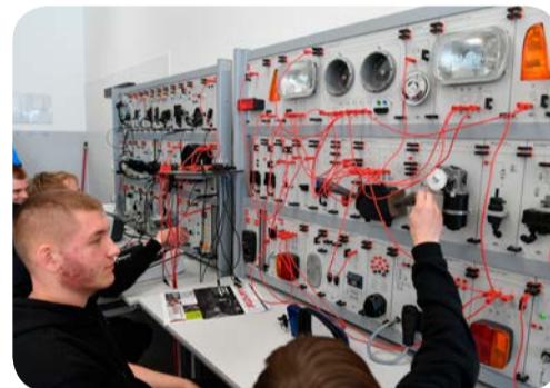
↗ Stanowisko demonstracyjne - oświetlenie pojazdu
